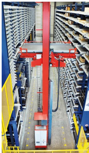
Das Regalbediengerät verfügt über ein Zahnstangenhubwerk.
